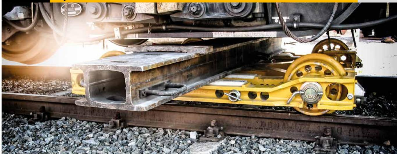
**Para la retirada y el transporte de vehículos ferroviarios con ruedas o pares de ruedas averiados.**
