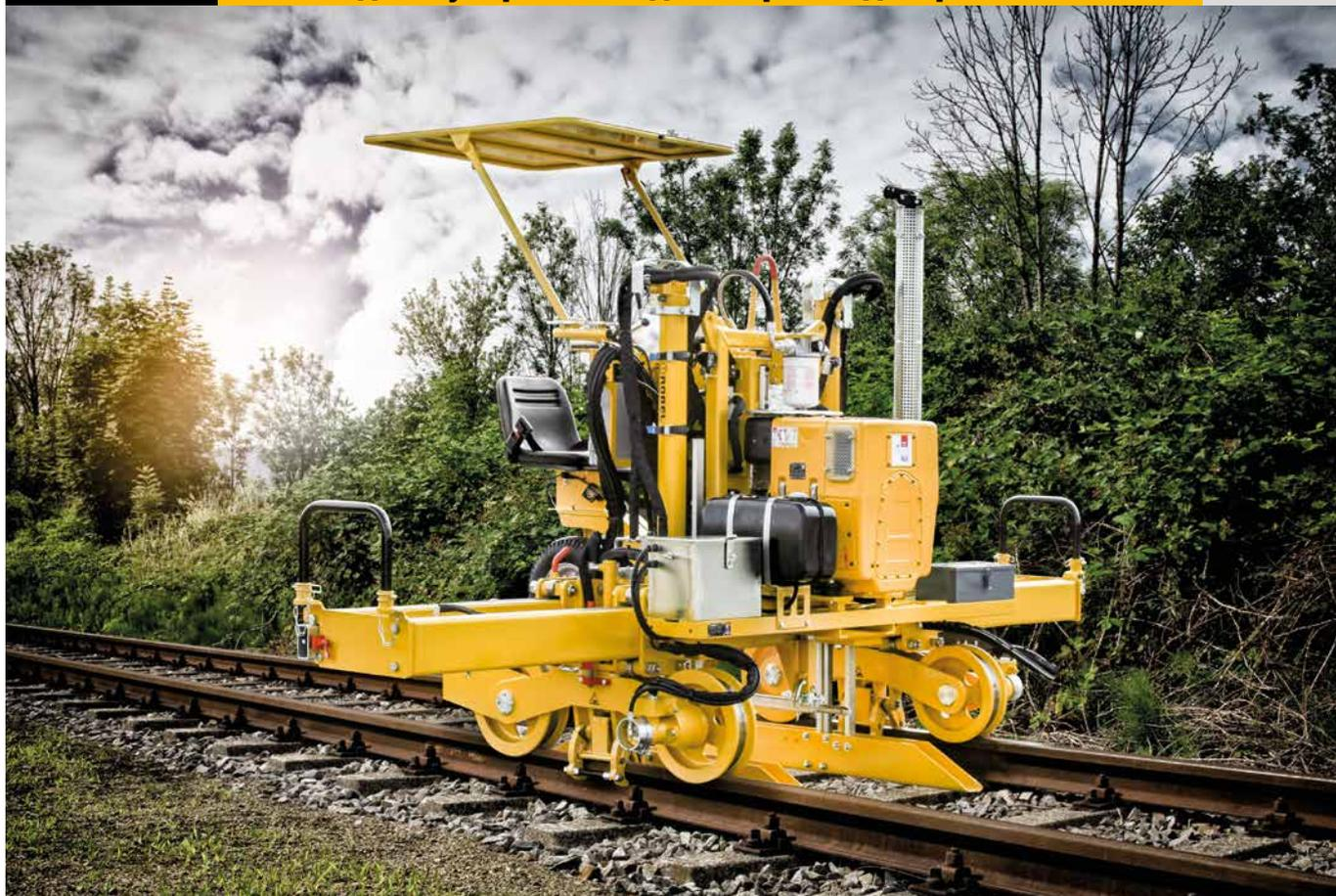
Для непрерывной, пошаговой перекладки рельсов с обеспечением требуемой ширины колеи. Гидравлические рельсозахватные механизмы захватывают головки рельсов и держат их надежно с защитой от кручения и падения, перемещая рельсы наружу или во внутрь
